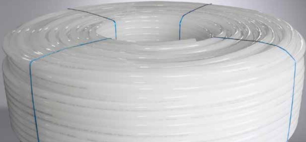
PE-Xa 5-Schicht-Rohr ist ein erstklassiges Kunststoffrohr für die raue Baustellenanwendung. Es wird auch als Klettvariante in Eigenproduktion gefertigt. Die Sauerstoffdurchlässigkeit liegt deutlich unter dem Grenzwert der DIN 4726. Durch die äußere Schutzschicht aus PE wird die EVOH-Sperrschicht vor Beschädigungen geschützt.
